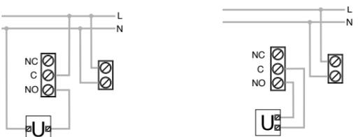
Schema di collegamento per alimentazione di pompe di circolazione, elettrovalvole, ecc. a 230V~
