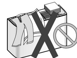
**ATTENZIONE:** Durante il funzionamento non posare oggetti o panni ad asciugare sulla griglia di uscita aria, ne ostruirebbero il passaggio con pericolo di danneggiamento dell'unità.
