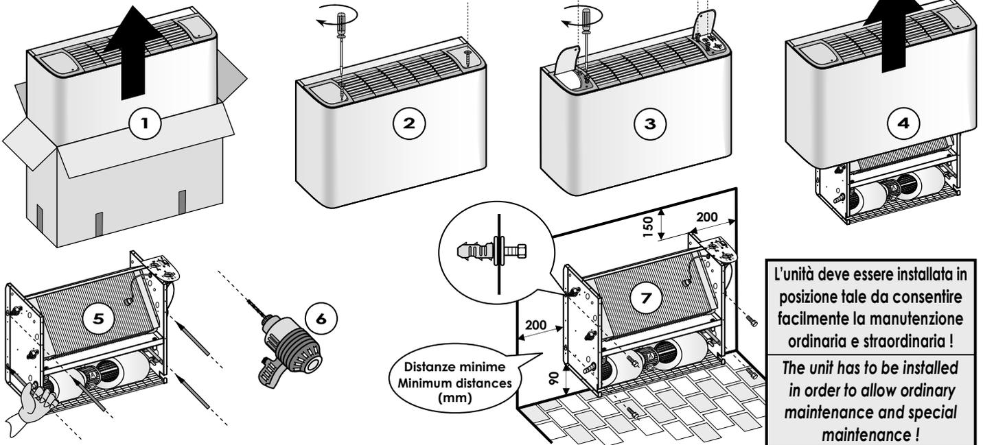
**Installazione: Collegamento idraulico - Installation: Water supply connections**
